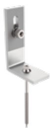
TM001 SUPORTE L SIMPLES Fixação simples utilizado em telhas metálicas. Todos os tipos de telhas metálicas. Composto por 1 parafuso de inox autobrocante de 100 mm
